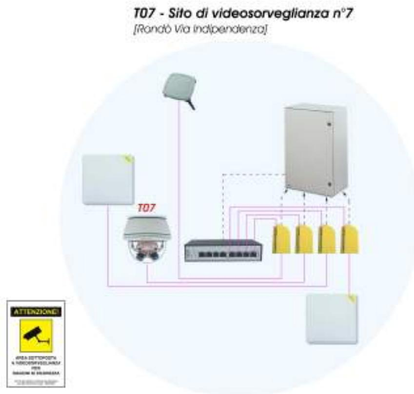
Figura 29. Esempio di installazione nel sito di videosorveglianza n°7
