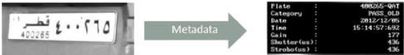
Figura 2. Esempio di lettura targa e conversione in dato informatico
