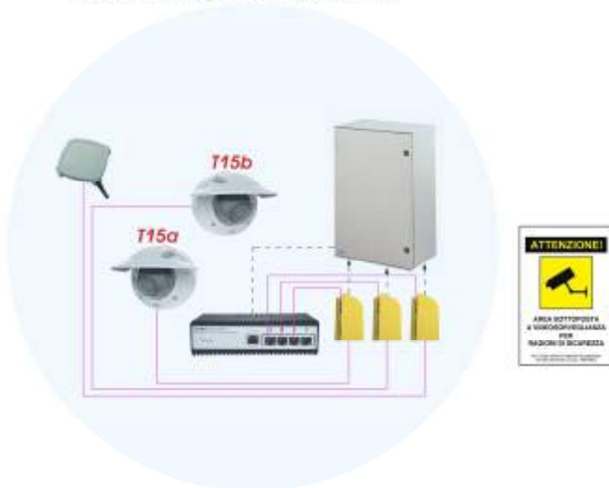
Figura 30. Esempio di installazione nel sito di videosorveglianza n°15
